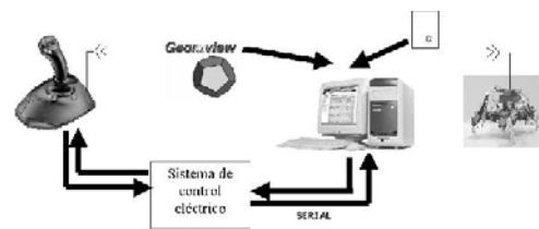
Figura 5 Diagrama del funcionamiento de al interfaz grafica con el dispositivo háptico y el robot multiarticulado.
