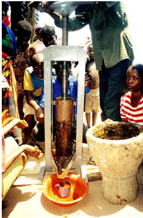
Fig. 6 Spindle press (Luapula, Zambia)
