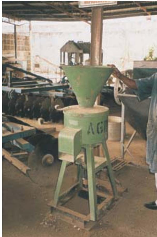
**Fig. 16 Palm nut cracker (AGRICO, Ghana)**
