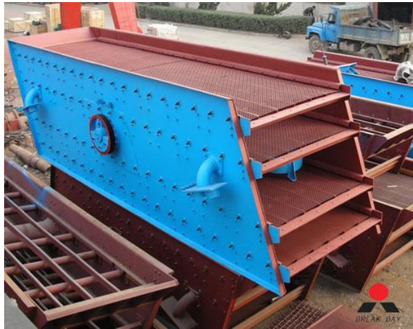
foto 21 criba de minerales
