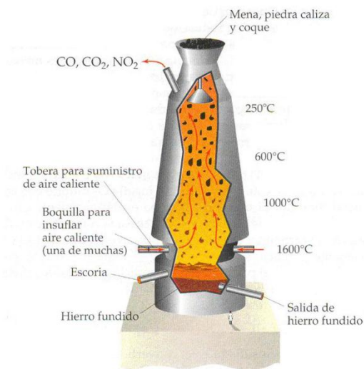
foto 10 zonas de reacción en un alto horno
