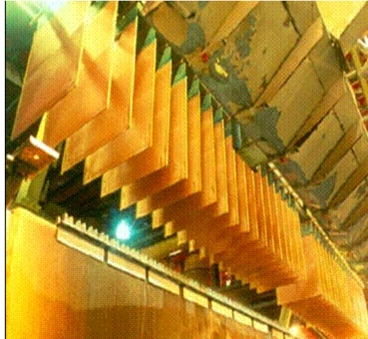
foto 17 cátodos de Cu refinados en una celda electrolítica
